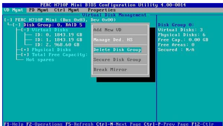
图 2-1 PERC 配置实用程序：Dell PowerEdge 720 硬件上会显示“Virtual Disk”（虚拟磁盘）初始页面
