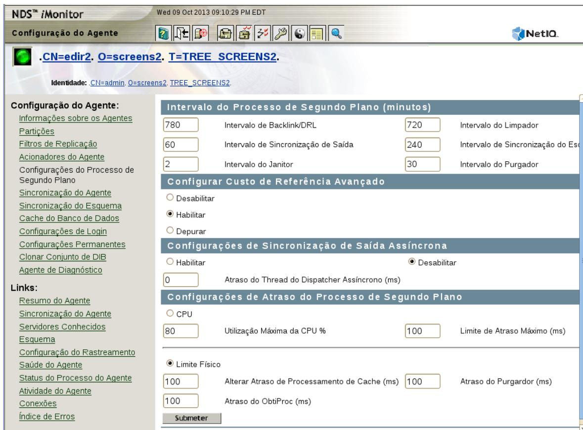
Testes internos em laboratório foram realizados em uma configuração de 10 servidores com as seguintes configurações: Limite físico- *0ms*, Sincronização de saída assíncrona - *habilitada* e Atraso de thread de dispatcher assíncrona - *0ms*. Os testes demonstraram que a replicação é sete vezes mais rápida do que as configurações padrão. Durante este teste, nenhuma outra operação do cliente foi realizada.
