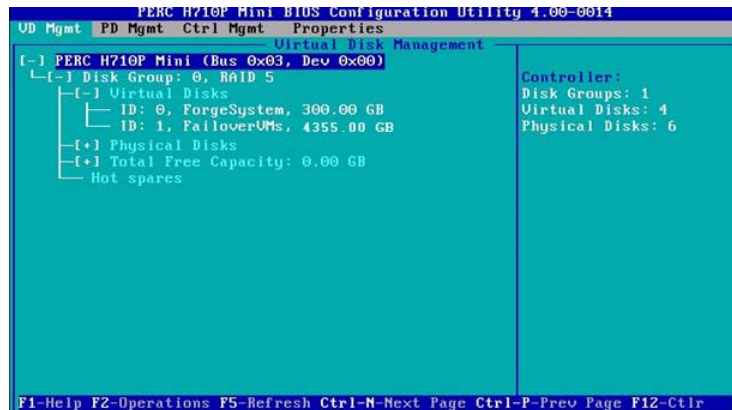
図 2-3 PERC Configuration Utility: Dell PowerEdge 720 ハードウェアの [仮想ディスク] ページの最終的な画面
