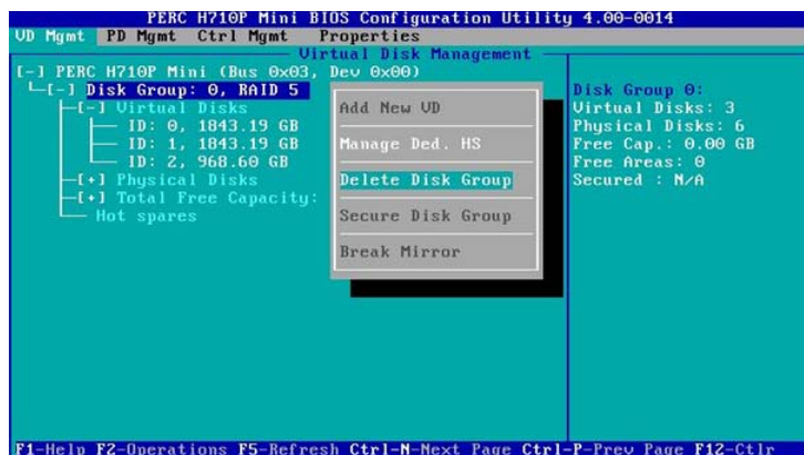
Figure 2-1 Utilitaire de configuration PERC : la page initiale « Disque virtuel » s'affiche sur le matériel Dell PowerEdge 720
