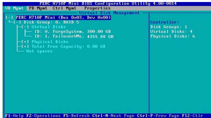
Figure 2-3 Utilitaire de configuration PERC : la page finale « Disque virtuel » s'affiche sur le matériel Dell PowerEdge 720
