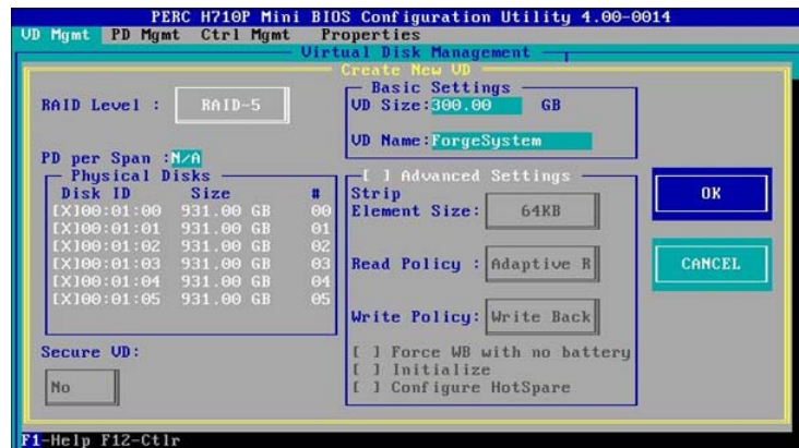
Figure 2-2 Utilitaire de configuration PERC : la page Créer un disque virtuel s'affiche sur le matériel Dell PowerEdge 720.
