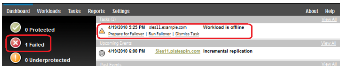
Figura 5-1 Página Dashboard (Consola) al detectar un error de carga de trabajo ( Workload is offline )
