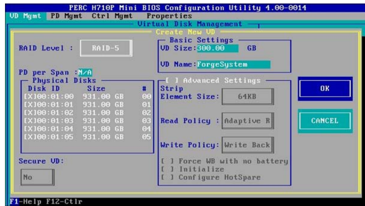
Abbildung 2-2 PERC-Konfigurationsprogramm: Die Seite „Neuen virtuellen Datenträger erstellen“ wird auf der Dell PowerEdge 720-Hardware angezeigt.
