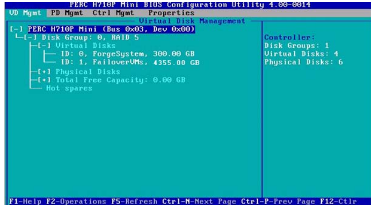
Abbildung 2-3 PERC-Konfigurationsprogramm: Die letzte Seite „Virtueller Datenträger“ wird auf der Dell PowerEdge 720-Hardware angezeigt.
