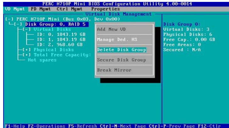
Abbildung 2-1 PERC-Konfigurationsprogramm: Die Startseite „Virtueller Datenträger“ wird auf der Dell PowerEdge 720-Hardware angezeigt.
