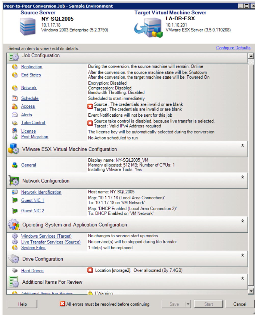
Figura 4-1 Ventana de trabajo de migración par a par (P2V en modo avanzado)
