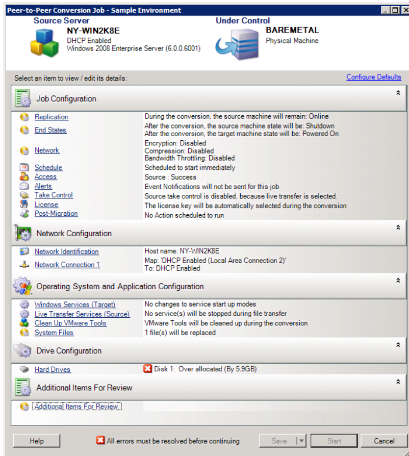
Figura 4-2 Ventana del trabajo de conversión par a par (V2P en modo avanzado)
