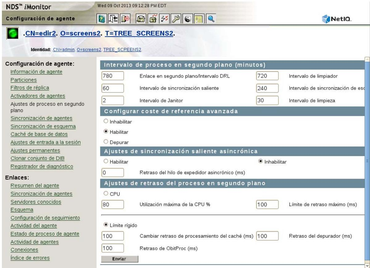
Se realizaron pruebas de laboratorio interna en una configuración de 10 servidores con los siguientes ajustes: límite rígido de 0 ms, sincronización saliente asincrónica *habilitada* y demora del hilo expeditor asincrónico de 0 ms. Las pruebas han demostrado que la replicación es siete veces más rápida que con los ajustes por defecto. Durante esta prueba, no se realizaron otras operaciones de cliente.
